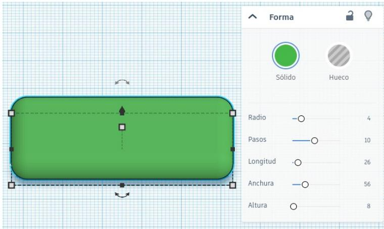
**Bloque 2º(Cubo).**- Cubo hueco para realizar el rebaje donde se van a ubicar las letras. Elevar 4 mm sobre el plano de trabajo. Centrar y agrupar con el bloque 1.
